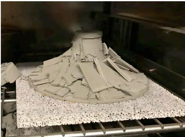
Abbildung 1: Über eine FFF Variante für Metallteile hergestelltes Bauteil nach erfolglosem Entbindern durch inhomogene Extraktion des Bindematerials.
